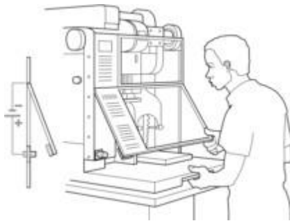
Figure N° 07 : Les protecteurs à verrouillage
