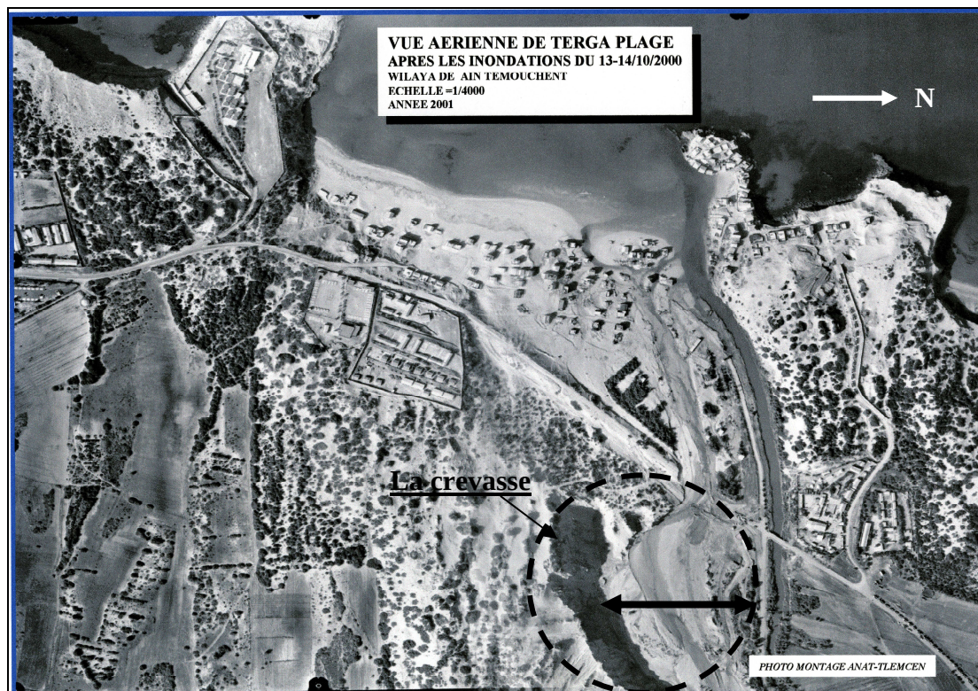
Photo 48 : une vue aérienne quelques jours après les inondations. A droite de la photo, on remarque l'élargissement de l'oued El Maleh due à l'extension de la sablière, le camp de toile et les cabanons de la partie nord de la plage sont envahis par les débordements de l'oued sur les zones proche de sa rive gauche INC, (2001).
