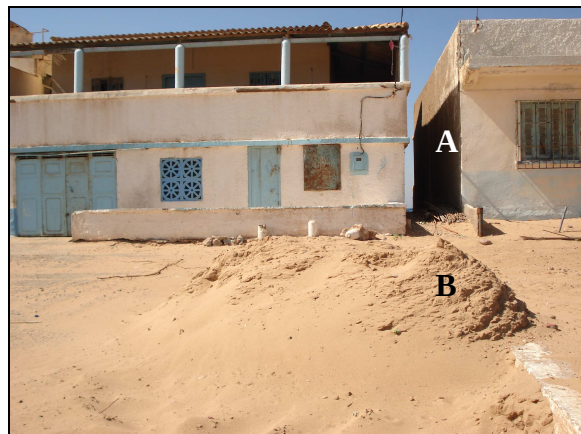
Photo 110 : L'espacement entre les constructions est vital pour l'équilibre du transfert sédimentaire entre la partie marine et la partie terrestre à Terga, A : vide entre maisons, B : accumulation sableuse Photo 111 : La disposition, dans les années cinquante, des anciennes maisons de plage à Terga sur la rive gauche de l'oued El Maleh
