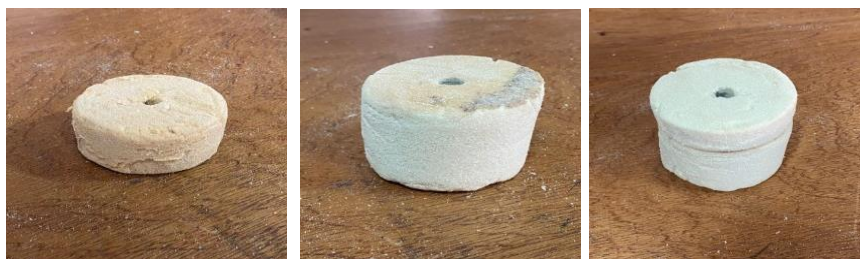
Figure 3.3- Echantillons de PU (déchet 2) et exposé au soleil et à l'humidité.
