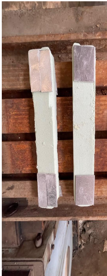
Figure 3.6-Échantillons de PU découpés et préparés pour essais mécaniques
