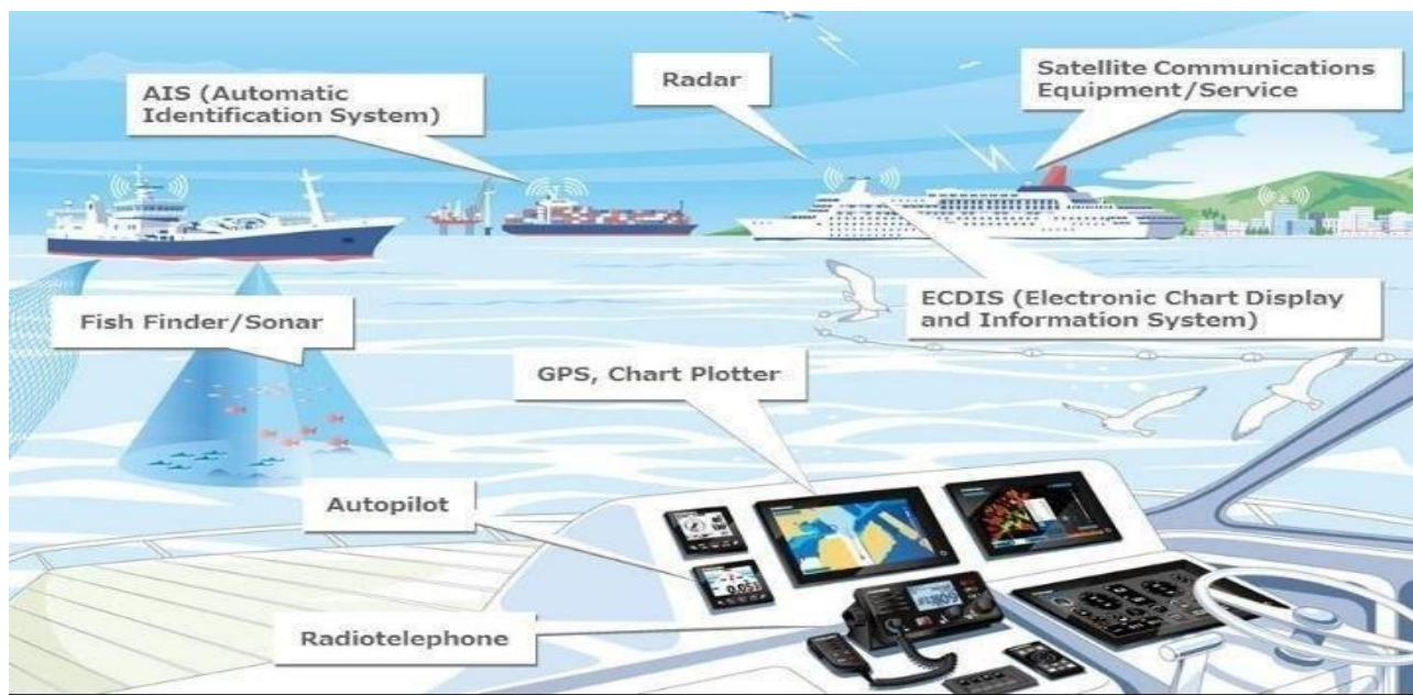
Figure I.5: Équipements de navigation à bord d'un navire de pêche
