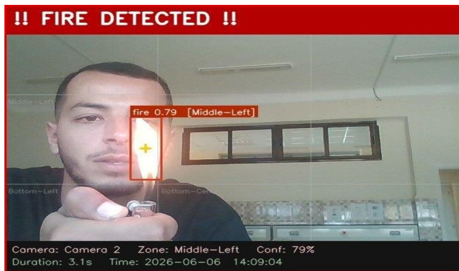
Figure III.13 détection du feu
