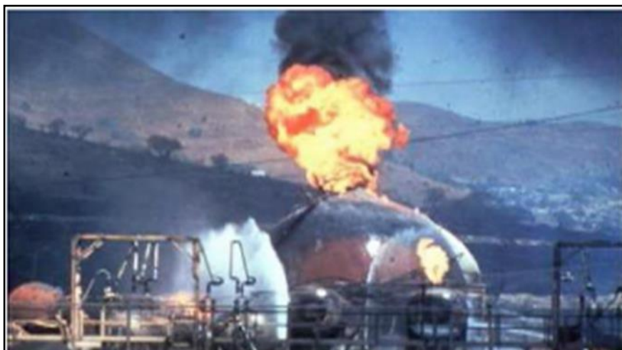
Figure 22 : BLEVE sphère de GPL (Benyamina, N)
