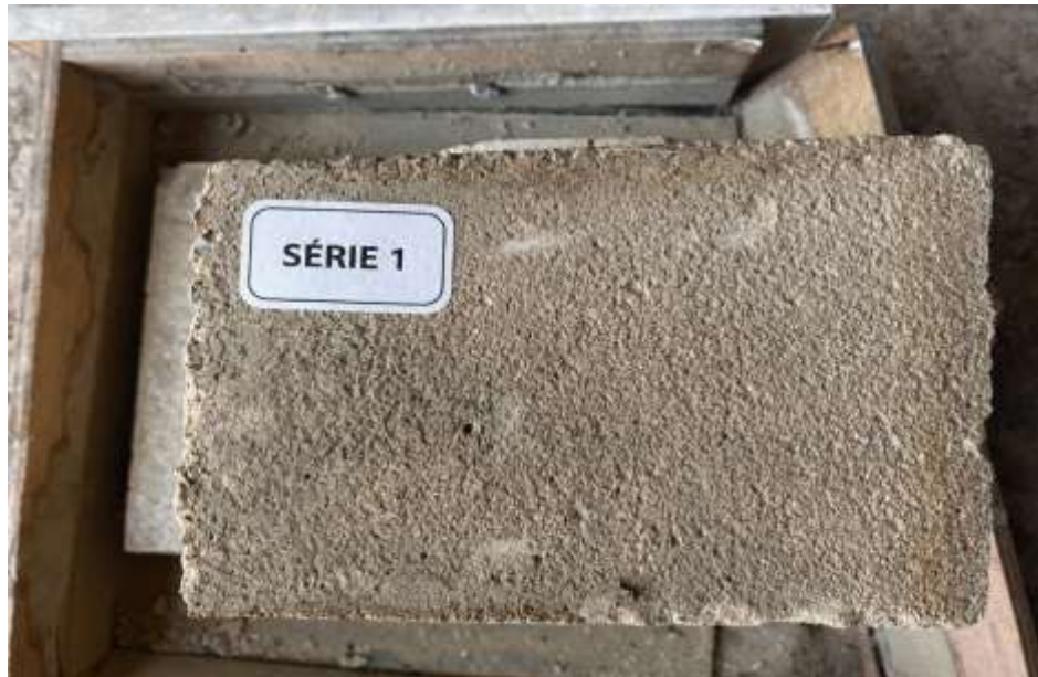
Figure2.36:pavé écologique fabriqué (série1)
