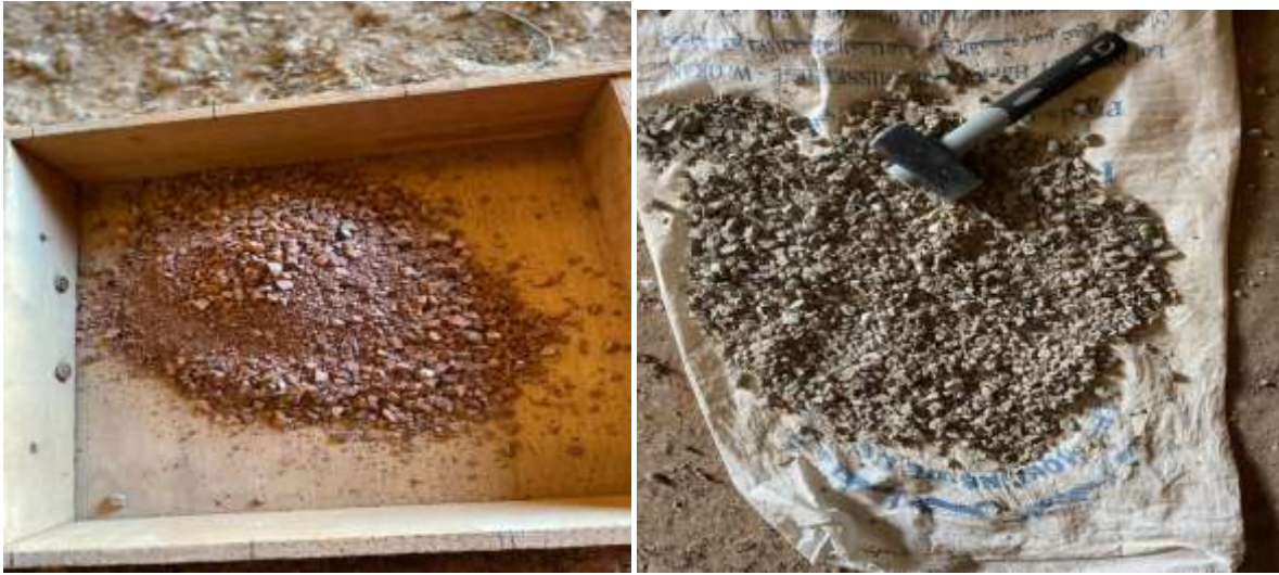
Figure2. 22:granulats de céramique et béton recyclés
