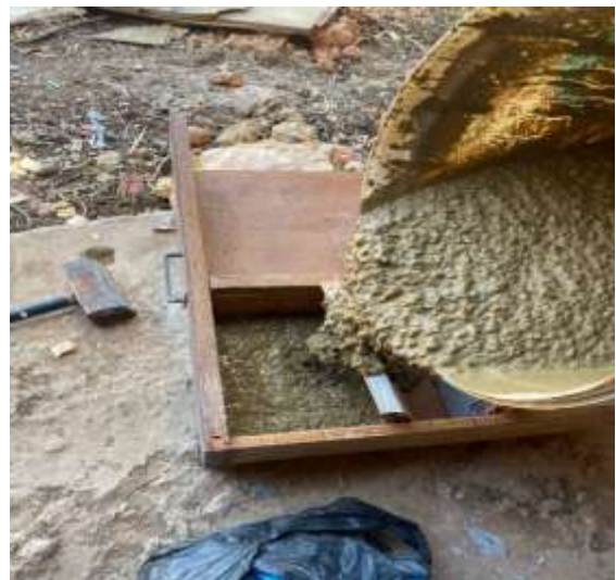
Figure 2.35: Mise en moule du mélange pour la fabrication des pavés écologiques
