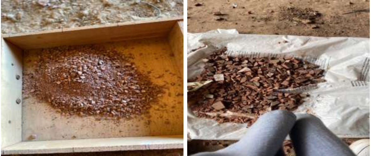
Figure2.27: Le concassage du céramique
