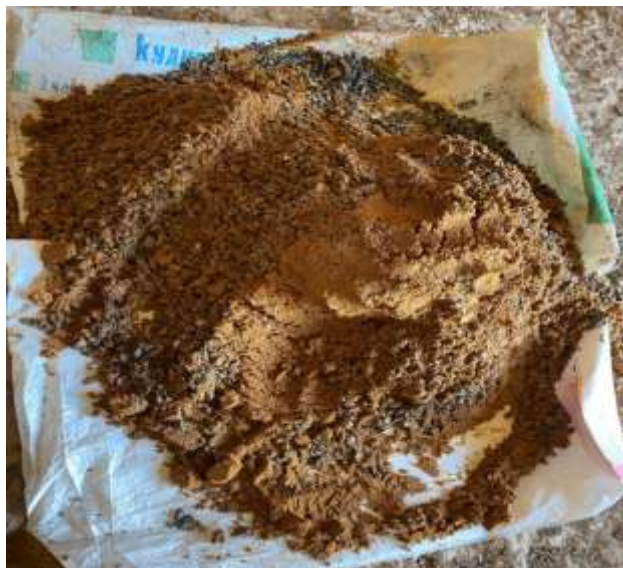
Figure2.33:mélange du sable, gravats et céramiques
