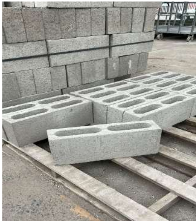
Figure1.20:blocs de maçonnerie
