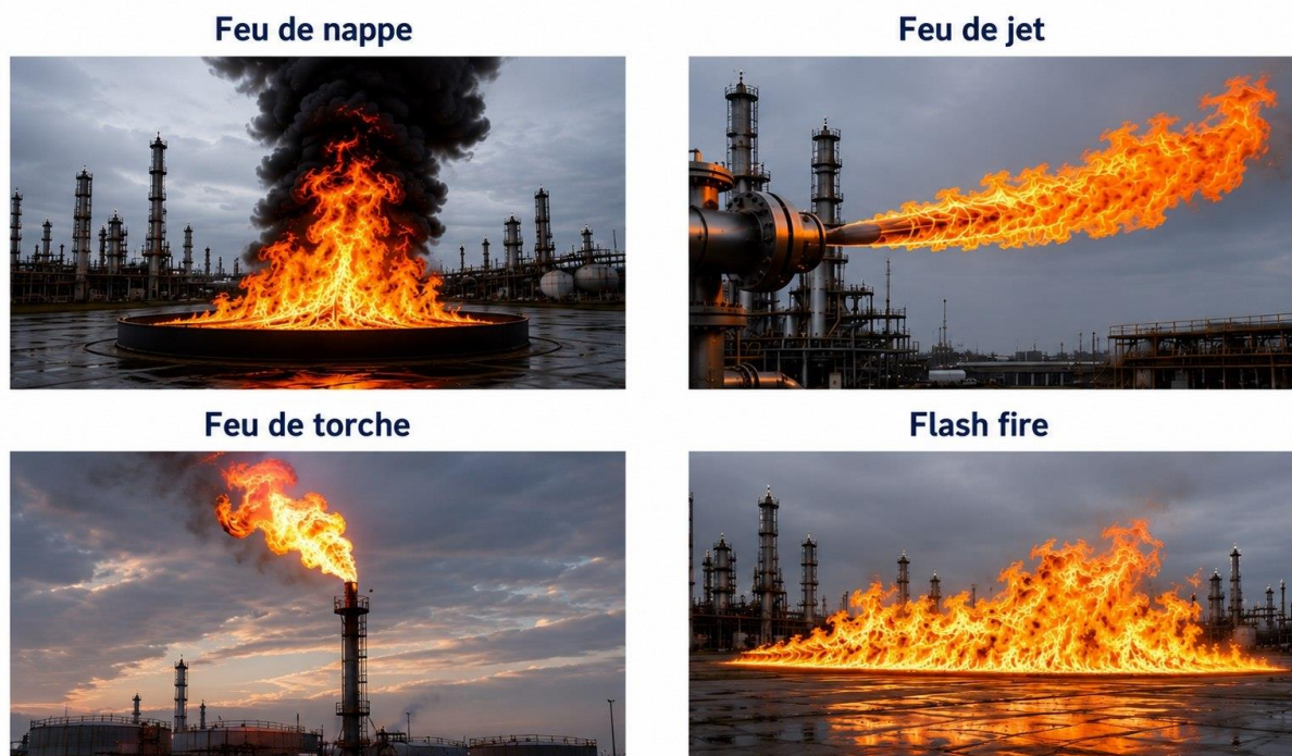
Figure 5 - Typologie des phénomènes thermiques associés aux fuites d'hydrocarbures-
