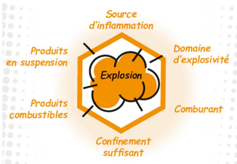
Figure 6 - Hexagone de l'explosion: les six conditions nécessaires -
