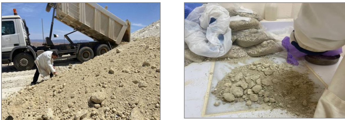
Fig.32 : Echantillonnage de tout venant
