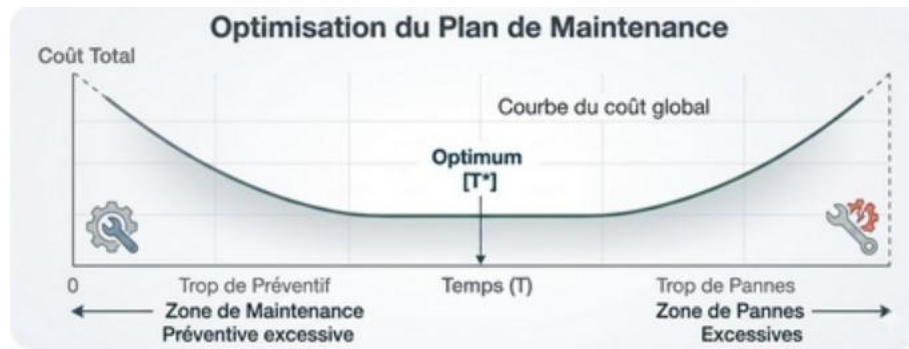
Figure III. 2: Courbe d'optimisation du coût total de maintenance en fonction de la périodicité T (Allure en "U")
