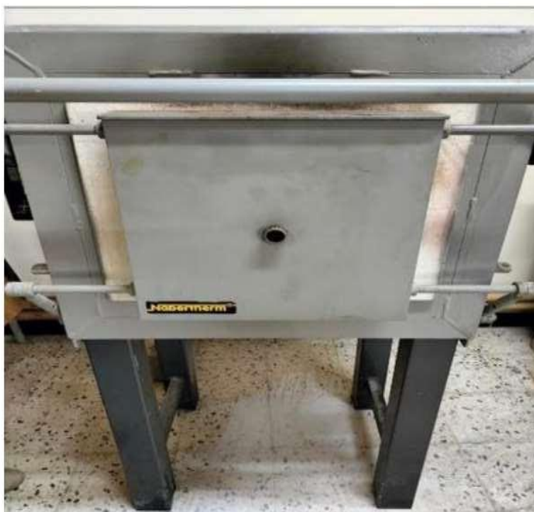
Figure 11: Four électrique a convection
