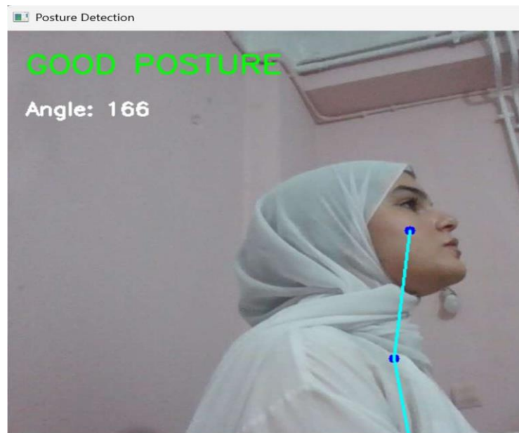
Figure 3.3 : L'opérateur assis bien droit, le squelette cyan bien aligné, l'angle >160^\circ et le texte vert "GOOD POSTURE"
