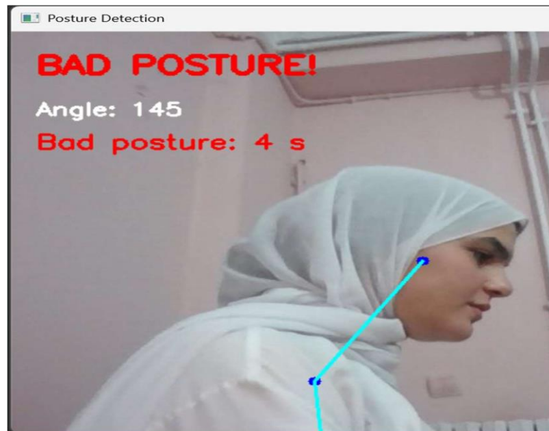
Figure 3.3 : L'opérateur affaissé vers l'avant, le squelette cyan courbé, l'angle <160^\circ et le texte rouge "BAD POSTURE!".
