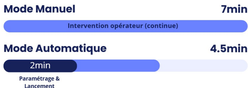
FIGURE 4.17. Comparatif des temps de cycle : mode manuel vs mode automatique
