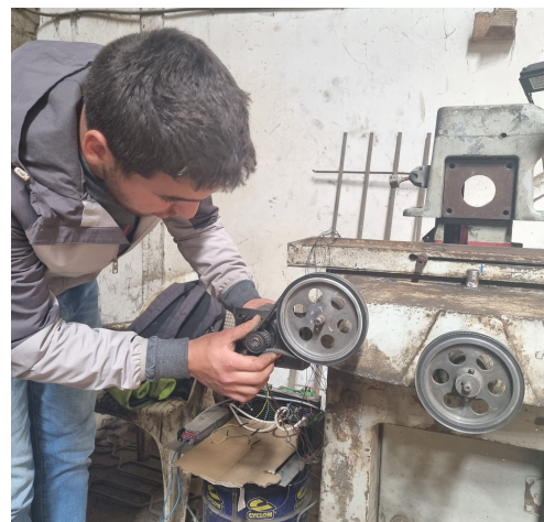
FIGURE 4.6. Dispositif de motorisation pas-à-pas et réduction par courroie crantée
