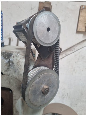
FIGURE 4.6. Dispositif de motorisation pas-à-pas et réduction par courroie crantée
