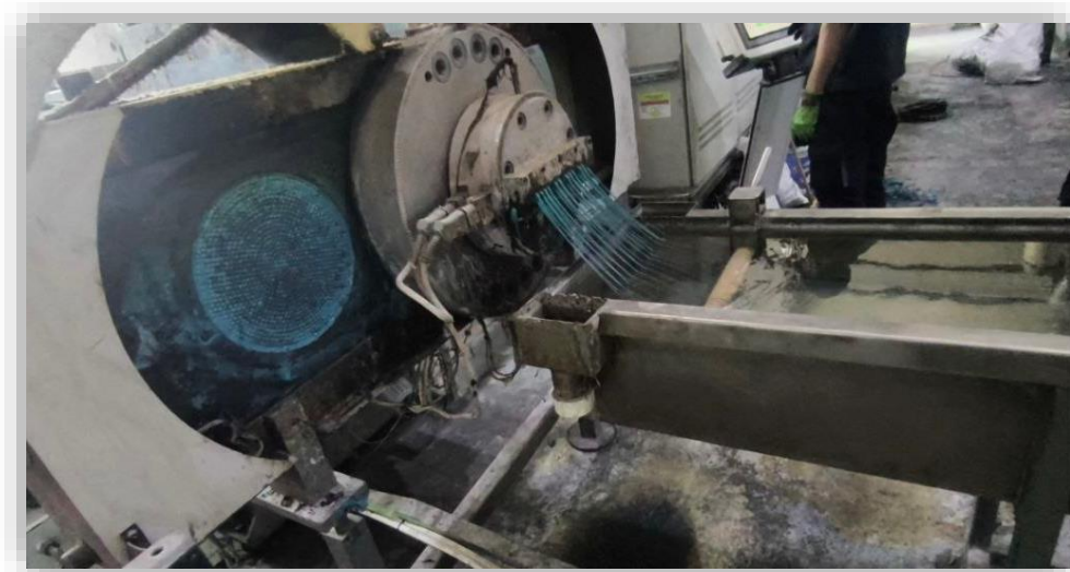
Figure II.11 : Refroidissement de filaments de plastique
