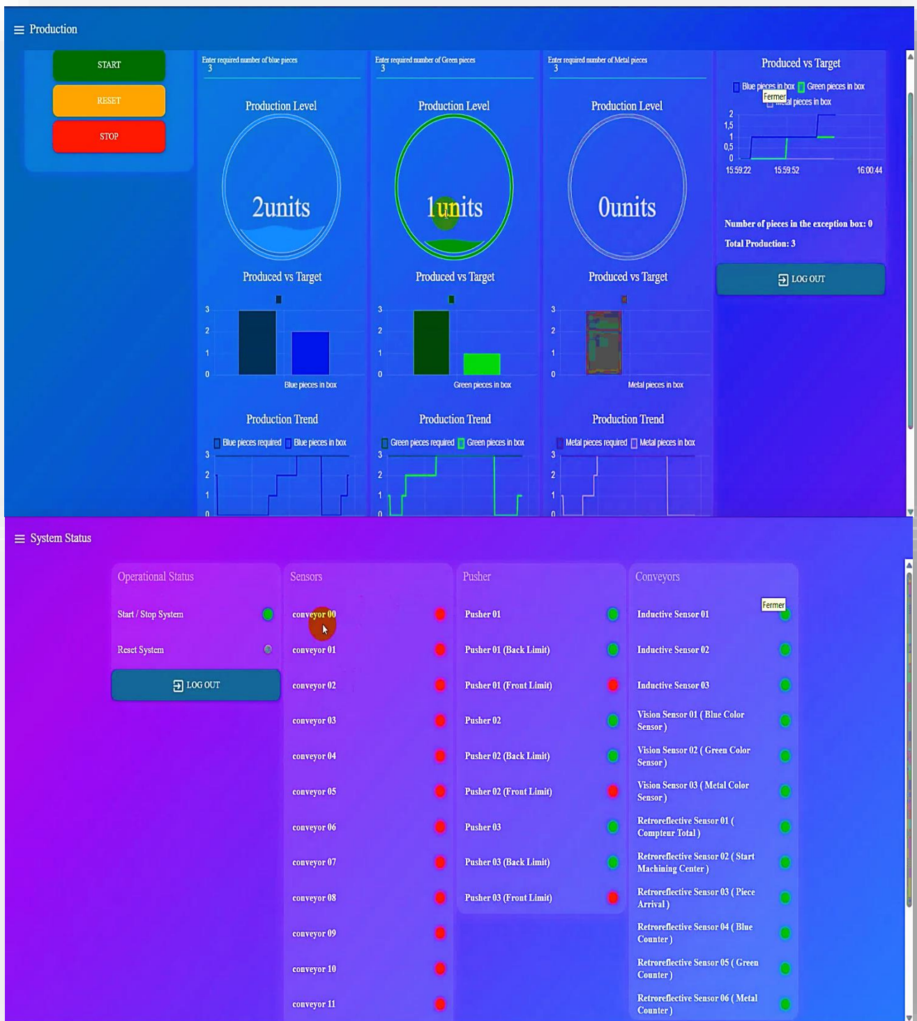
Figure III.68 : Interface de supervision et de contrôle du système de tri sous Node-RED
