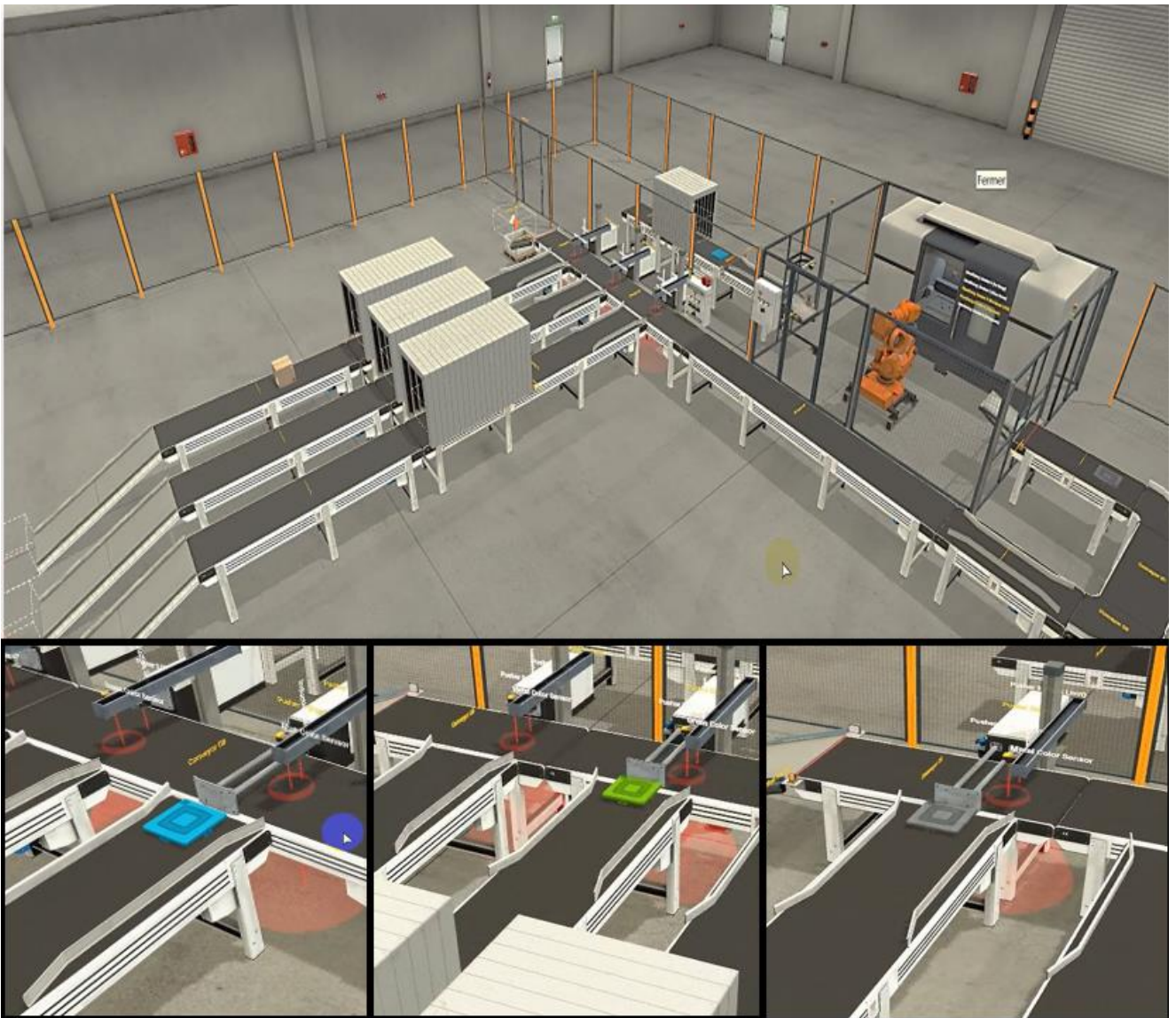
Figure III.55 : Fonctionnement du système de tri selon la couleur et la nature de la pièce
