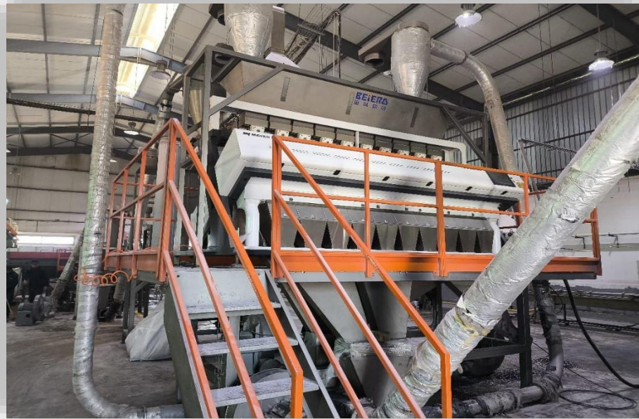
Figure II.9 : station de triage par couleur automatisée
