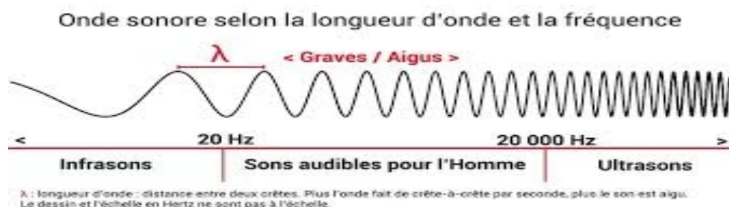
Figure 10: Onde sonore selon la longueur d'onde et la fréquence [37].
