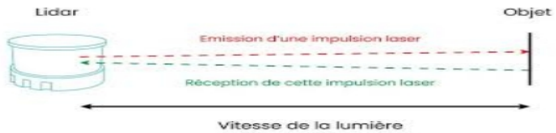
Figure 5: Schéma illustre le principe de fonctionnement d'un LiDAR [32].
