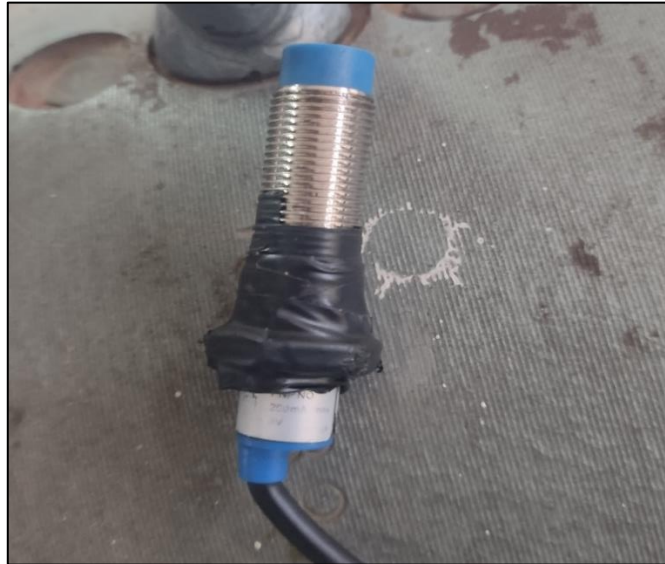
FigureIII.5 - Capteur de régime moteur (LJ12A3-4-Z/BX-5V)
