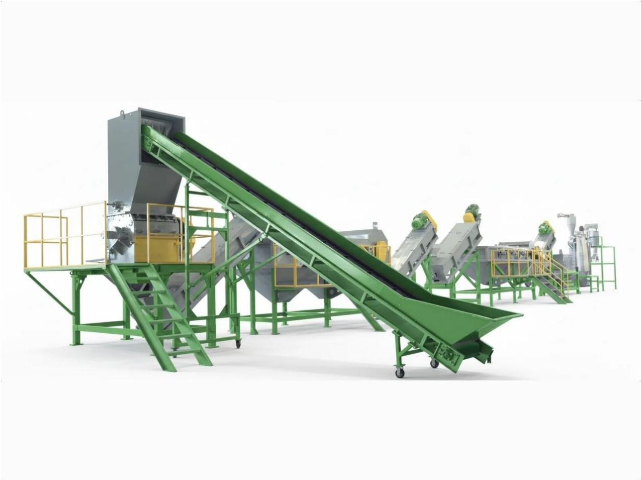
Figure II.25: représente ligne de lavage
