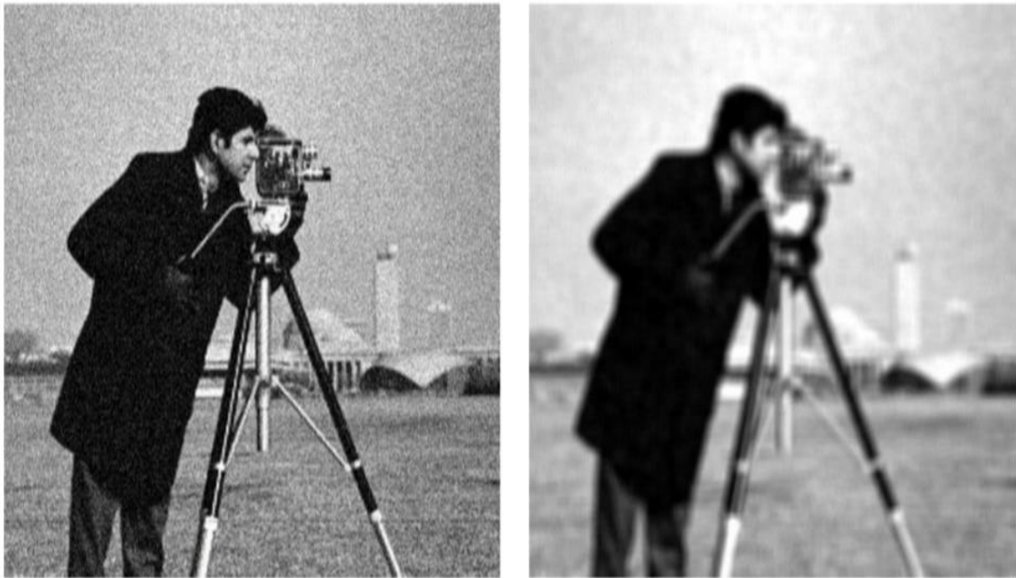
Figure 14: Application du filtre moyenné (lissage) pour la réduction du bruit dans une image.
