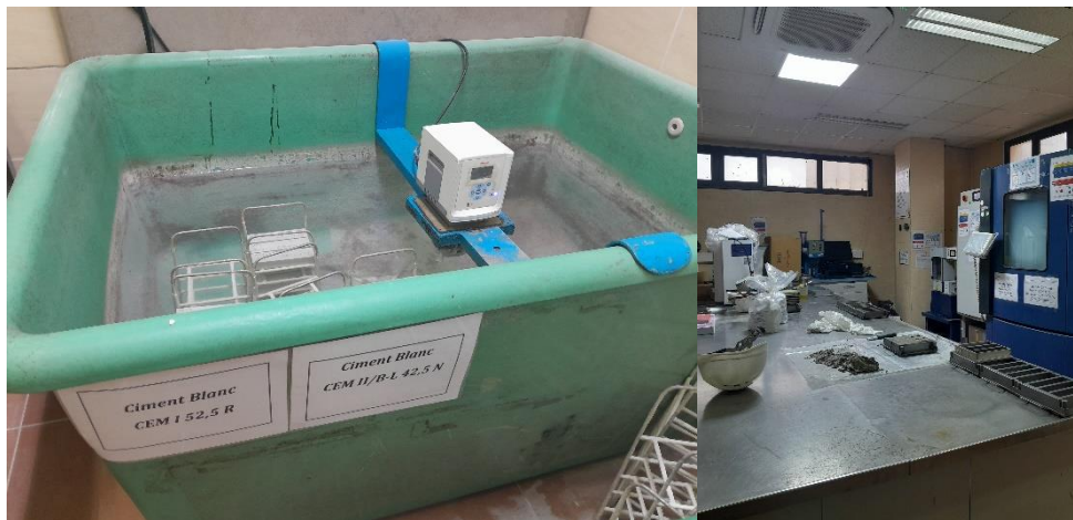
Figure I-11. Laboratoire de contrôle (cure + tests du ciment/béton)
