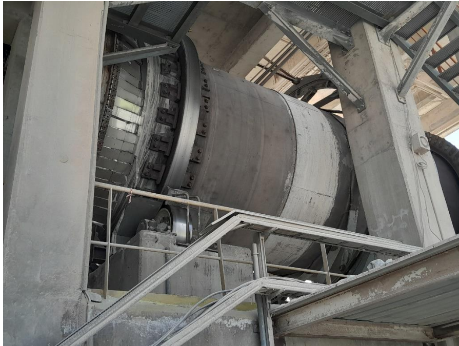
Figure I-8. Refroidisseur rotatif de l'eau dans la production de ciment blanc.
