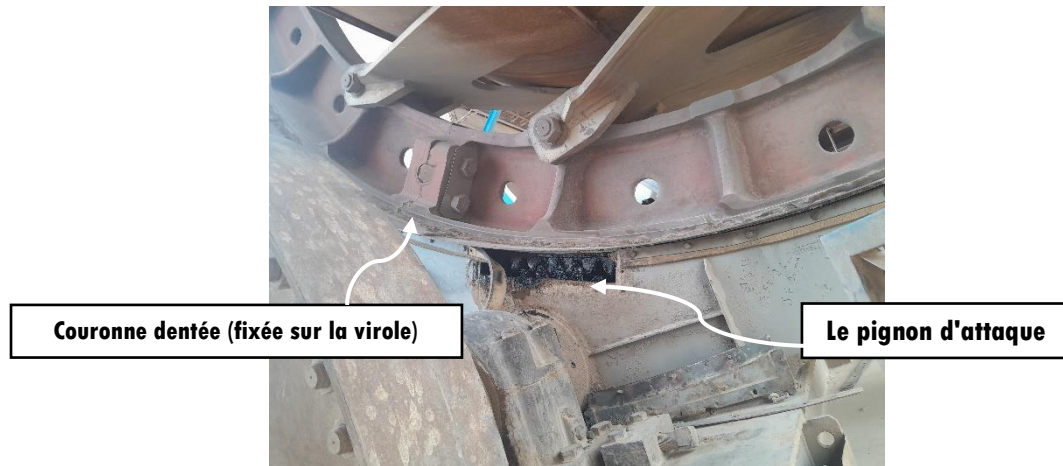
Figure I-19. Couronne dentée d'un four rotatif
