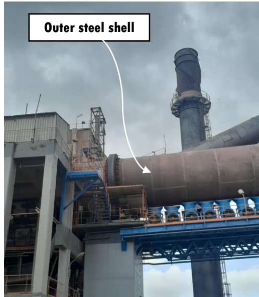
Figure I-14. Virole d'un four rotatif
