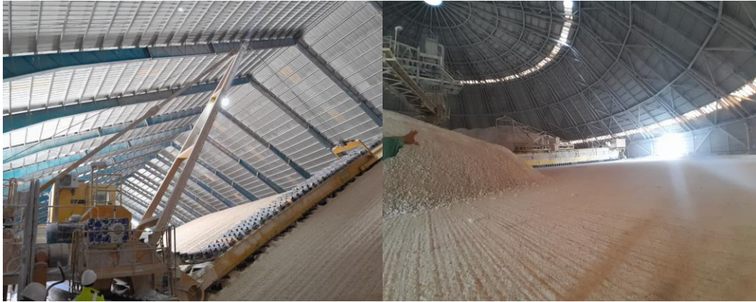
Figure I-5. Les machines de stacker et reclaimier
