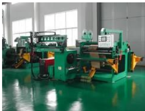
Figure 2-3 : Enroulement en couches
