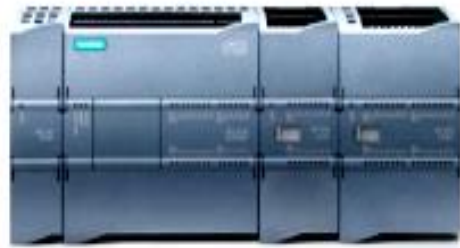
Figure I.7 : Automatisme modulaire Siemens.
