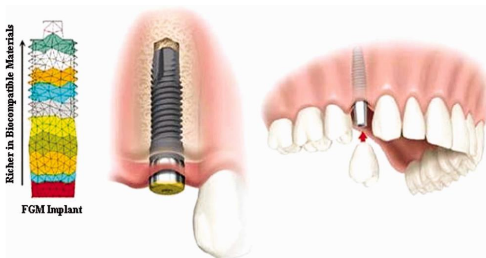
Figure 1.14 : Vue schématique d'un implant dentaire FGM (gradient HA/Ti) [20]
