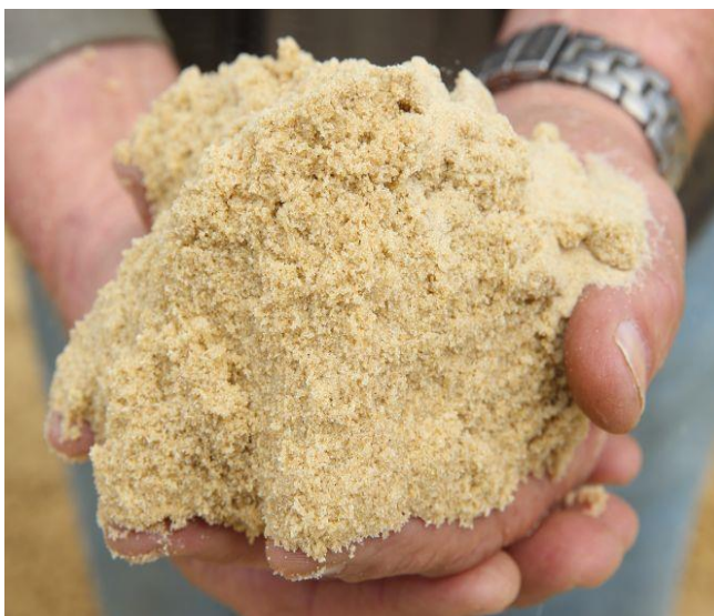
Photo 12: produit semi-final (sable siliceux) après le traitement
