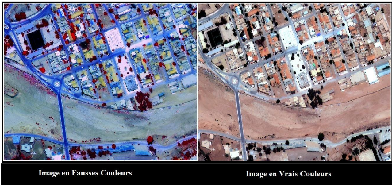
Figure 23: Fusion de l'image PAN avec les Multispectrales Figure 30: fusion de l'image PAN avec les Multispectrales
