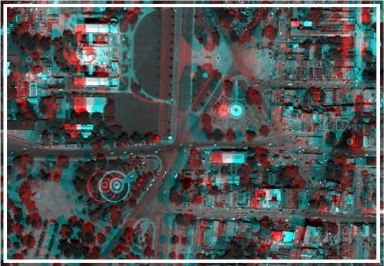
Figure 17: Vue en mode stéréo montrant la parallaxe entre les acquisitions avant et arrière.
