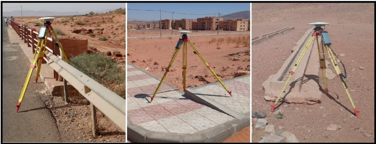
Figure 15: le positionnement GNSS en Statique Rapide.
